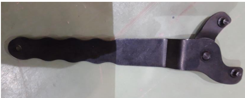
Kuva 1. Asiakas toimitti työkalun jälkiasennettavan tukirenkaan asentamista varten.
